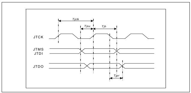
Figure 11-6. JTAG AC Timing Diagram
